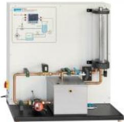
L'appareil d'essai constitue une introduction expérimentale étendue aux principes de base de la technique de régulation à l'exemple d'une régulation de niveau.
