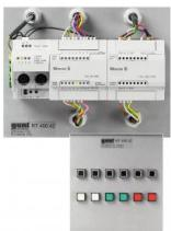
L'automate programmable industriel (API) est installé d'origine sur une plaque qui se fixe facilement et rapidement sur le bâti du module de base RT 450.
