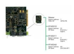
La communication entre un PC et des composants dautomatisation via un bus de terrain constitue une solution standard usuelle
