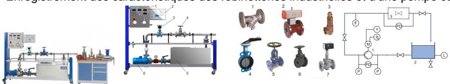
Le banc dessai RT 396 permet la comparaison de différentes robinetteries du point de vue de leurs caractéristiques. Les quatre catégories typiques de robinetteries, robinet, robinet-vanne, clapet et soupape sont représentées par un robinet à tournant sphérique, un clapet, un robinet-vanne, une soupape d'arrêt et une vanne de régulation. On examine en outre une soupape de sécurité et un collecteur d'impuretés.
