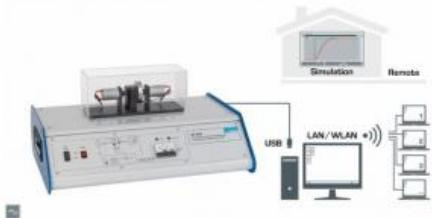
Le RT 050 propose des essais de base sur un système réglé de vitesse de rotation.
