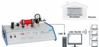
Le RT 030 propose des essais de base sur un système réglé de pression.
