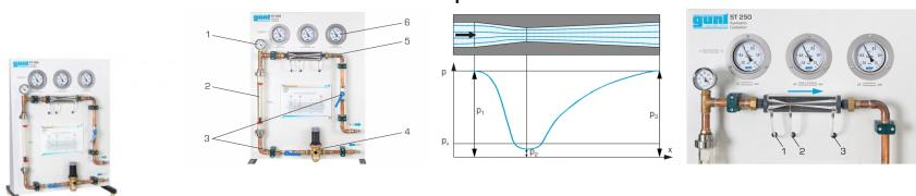
On appelle cavitation le phénomène de formation de bulles de vapeur dans des liquides en écoulement suite à de fortes dépressions.
