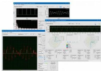
L'analyseur de vibrations assisté par ordinateur a été développé spécialement pour permettre l'interprétation des essais pour le diagnostic de machine de la série PT 500.
