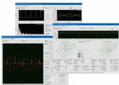
L'analyseur de vibrations assisté par ordinateur a été développé spécialement pour permettre l'interprétation des essais pour le diagnostic de machine de la série PT 500. Mais l'appareil de mesure peut également être utilisé avec profit pour de nombreux autres essais relatifs aux vibrations (p. ex. TM 150).
