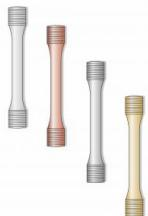
Ce jeu d'éprouvettes est disponible en accessoire pour l'appareil d'essai WP 300.
