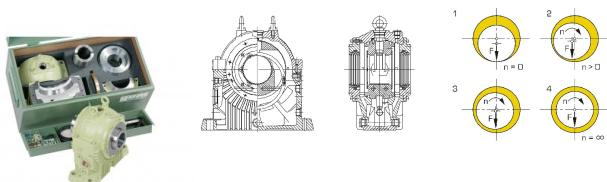
Sur les paliers lisses, un mouvement de glissement a lieu généralement entre un tourillon et un coussinet de palier. Ce mouvement de glissement est habituellement lubrifié par un fluide intermédiaire.
