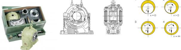
Sur les paliers lisses, un mouvement de glissement a lieu généralement entre un tourillon et un coussinet de palier. Ce mouvement de glissement est habituellement lubrifié par un fluide intermédiaire.
