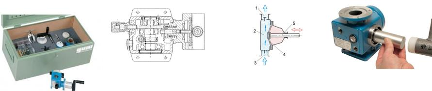
Les pompes à diaphragme font partie des pompes volumétriques et fonctionnent par oscillation, à aspiration normale.
