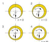
Sur les paliers lisses, un mouvement de glissement a lieu généralement entre un tourillon et un coussinet de palier. Ce mouvement de glissement est habituellement lubrifié par un fluide intermédiaire. Les paliers lisses hydrodynamiques conviennent pour un fonctionnement continu sans usure, les grands diamètres, les vitesses de rotation élevées, et les fortes charges par à-coups.
