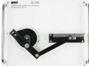
Le mécanisme de Whitworth est aussi connu sous le nom de "mécanisme à retour rapide".
