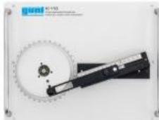
Un mécanisme bielle-manivelle est un groupe fonctionnel que l'on trouve dans des machines et qui sert à transformer un mouvement de rotation (rotatif) uniforme en un mouvement de va-et-vient (translationnel) et inversement.
