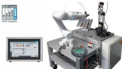
La fonction principale de l'installation d'essai IA 500 est de transformer un processus manuel dans le cas présent, un essai de traction classique en un processus entièrement automatisé.
