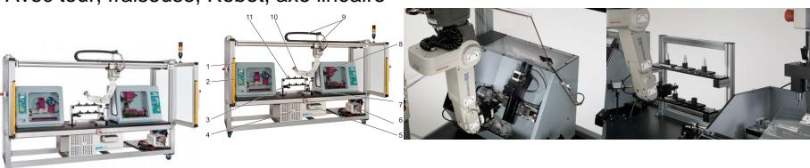
Le système didactique IA 520 présenté ici représente une cellule de fabrication entièrement opérationnelle, également appelée cellule CIM (CIM = Computer Integrated Manufacturing).
