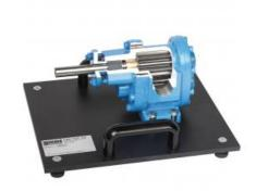
Véritable pompe à engrenages transformée en modèle en coupe. Montée sur un socle.
