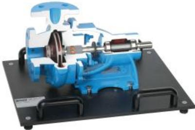
Pompe centrifuge simple étage normalisée, transformée en modèle en coupe.
