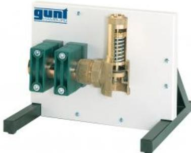
Véritable soupape de sûreté transformée en modèle en coupe.
