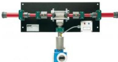
Le débitmètre à vortex est monté dans le circuit deau du banc dessai HM 500.
