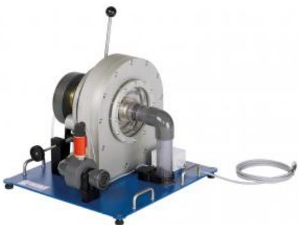
La turbine Francis fait partie des turbines à surpression qui transforment l'énergie de pression de l'eau en énergie cinétique dans le distributeur et dans le rotor.
