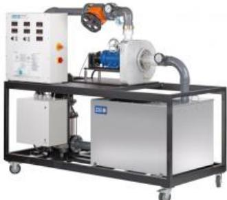
La turbine Francis fait partie des turbines à réaction qui transforment l'énergie de pression du fluide de travail en énergie cinétique dans le distributeur et dans le rotor.
