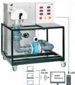
Les turbines à eau sont des turbomachines qui servent à transformer l'énergie de l'eau en énergie mécanique. Dans la plupart des cas, elles sont utilisées pour entraîner des génératrices pour la production électrique.
