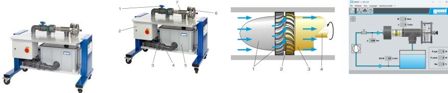
La turbine axiale travaille comme une turbine à réaction, comme on en trouve dans la construction de turbines au gaz et à vapeur.
