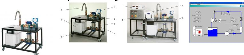
Avec l'unité d'alimentation HM 365.32, associée à HM 365.31, il est possible de faire fonctionner et d'étudier le comportement caractéristique de fonctionnement d'une turbine Pelton et d'une turbine Francis.
