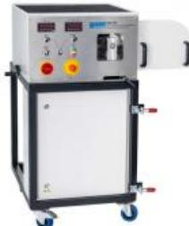
Le HM 365 est le module de base de la série FEMLine; il permet de réaliser des études et des expériences sur des machines à fluide.
