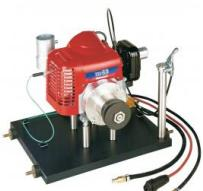
En combinaison avec le banc d'essai CT 159 et le dispositif de freinage et d'entraînement HM 365, le moteur essence deux temps simple convient parfaitement à l'enseignement des principes de base du fonctionnement et de la technique de mesure sur moteurs.
