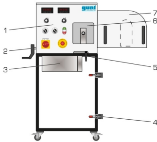
1 éléments d'affichage et de commande, 2 broche du dispositif de tension de la courroie trapézoïdale, 3 résistance de charge, 4 fermeture à genouillère, 5 levier de blocage du dispositif de tension, 6 trappe de service transparente, 7 toile de protection de la courroie trapézoïdale
