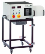
1 Réseau d'entraînement et de commande, 2 Boîtier de dispositif de freinage de la courroie trapézoïdale, 3 Résistance de charge, 4 Fermeture à genouillère, 5 Serrin de réglage du dispositif de freinage, 6 Boîtier de service transparent, 7 Site de projection de la courroie trapézoïdale
