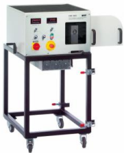
1 élément d'affichage et de commande, 2 broche du dispositif de tension de la courroie trapézoïdale, 3 résistance de charge, 4 fermeture à genouillère, 5 entre de serrage du dispositif de tension, 6 trappe de service transparent, 7 tôle de protection de la courroie trapézoïdale
