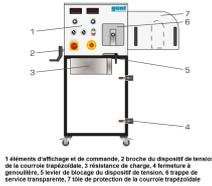
1 élément d'affichage et de commande, 2 broche du dispositif de tension de la courroie trapézoïdale, 3 résistance de charge, 4 fermeture à genouillère, 5 entretoise de réglage du dispositif de tension, 6 trapèze de service transparent, 7 tôle de protection de la courroie trapézoïdale
