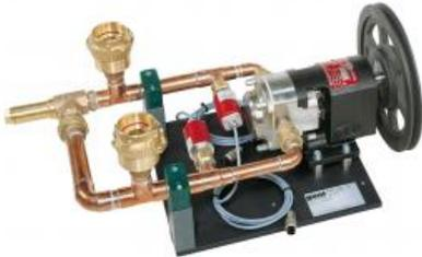
Contrairement à la pompe d'écoulement, la pompe volumétrique transporte le milieu par des chambres de refoulement fermées.
