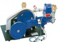
Les pompes à piston font partie du groupe des pompes volumétriques.
