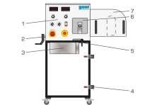
1 élément d'affichage et de commande, 2 broche du dispositif de tension de la courroie trapézoïdale, 3 valance de dragage, 4 interrupteur à genouillère, 5 servit de réglage du dispositif de tension, 6 trappe de service transparente, 7 tôle de protection de la courroie trapézoïdale
