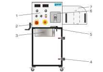
1 élément d'affichage et de commande, 2 broche du dispositif de tension de la courroie trapézoïdale, 3 résistance de charge, 4 fermeture à genouillère, 5 entretoise de réglage du dispositif de tension, 6 trappe de service transparente, 7 tôle de protection de la courroie trapézoïdale
