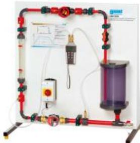
**HM 300 Circuit hydraulique avec une pompe centrifuge, mesure de delta de pression (Réf. 070.30000)**
