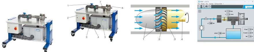
La turbine axiale travaille comme une turbine à réaction, comme on en trouve dans la construction de turbines au gaz et à vapeur.
