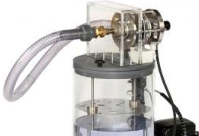
Les turbines à réaction et les turbines à surpression sont caractérisées par la transformation de l'énergie de pression en énergie cinétique dans le rotor.
