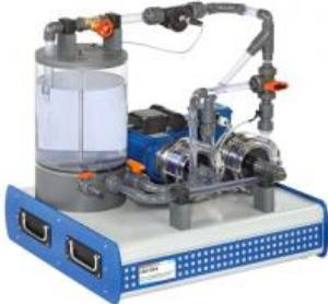
Dans les installations complexes, il est possible d'utiliser des pompes montées en série ou en parallèle. Les hauteurs de refoulement s'ajoutent pour le montage en série, et les débits de refoulement s'ajoutent pour le montage en parallèle.
