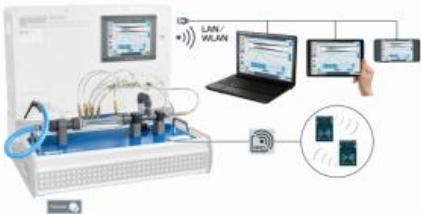
L'accessoire HM 250.07 est utilisé pour étudier la relation entre la vitesse découlement dun fluide et sa pression dans une buse Venturi.
