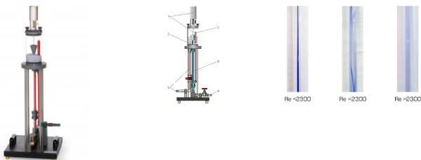
Un écoulement laminaire et un écoulement turbulent sont représentés durant lessai d'Osborne Reynolds. On peut alors observer, à partir d'une vitesse seuil, la transition entre écoulement laminaire et écoulement turbulent. Pour déterminer si un écoulement est laminaire ou turbulent, on utilise le nombre de Reynolds.
