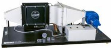
Les lignes de courant de l'écoulement stationnaire sont visualisées dans la soufflerie à l'aide de brouillard, de fumée ou de fils.
