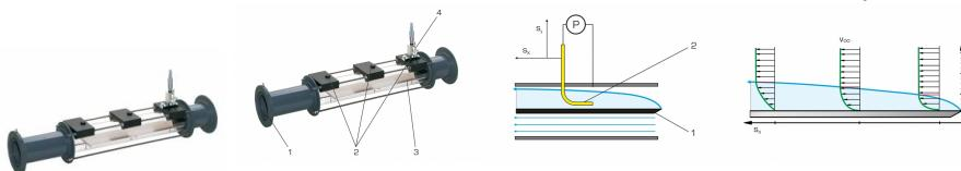
Ce qu'on appelle couche limite se forme le long d'une surface d'un corps soumis à un écoulement incident par l'adhésion du fluide qui s'écoule, par ex. l'air.
