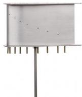
HM 170.27 avec profil d'aile NACA 4415 permet - en liaison avec la soufflerie HM 170 - d'enregistrer la distribution de la pression.
