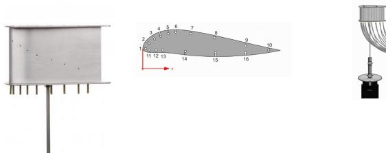
HM 170.26 avec profil d'aile NACA 54118 permet - en liaison avec la soufflerie HM 170 - d'enregistrer la distribution de la pression.
