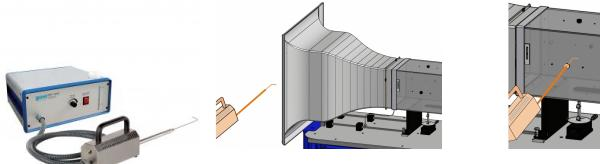
Pour visualiser l'écoulement, le générateur de brouillard HM 170.52 produit un brouillard particulièrement dense en évaporant un mélange de glycol liquide.
