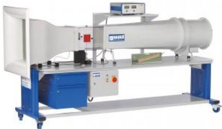
La soufflerie ouverte est l'appareil classique utilisé pour les essais réalisés sur les écoulements aérodynamiques.
