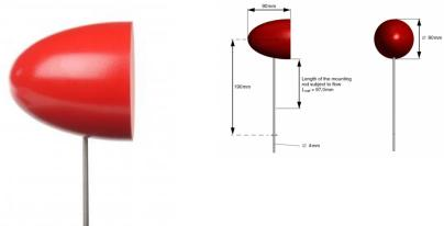
Le corps de résistance paraboloïde est étudié dans la section de mesure de la soufflerie HM 170.
