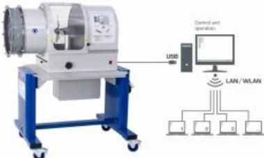
Avec la soufflerie HM 170, HM 170.70 permet la démonstration d'une éolienne avec ajustage des pales du rotor et générateur à vitesse de rotation variable.
