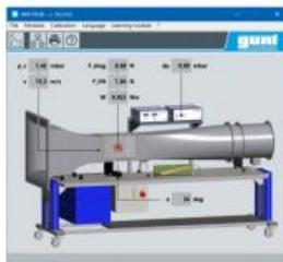
Le système d'acquisition des données a été spécialement mis au point pour simplifier l'analyse des essais réalisés avec la soufflerie HM 170.
