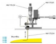
La mesure électronique du déplacement HM 170.61 est un accessoire destiné au système dacquisition des données HM 170.60 et est utilisée lors de l'analyse de la couche limite HM 170.24 afin de détecter électroniquement la position verticale du tube de Pitot.
