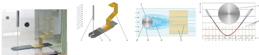
Lorsque des profils de corps sont soumis à un écoulement autour de corps, on assiste à la formation d'écoulements sur la couche limite.
