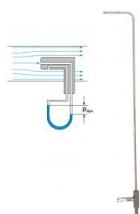
Le tube de Prandtl fournit la différence entre la pression totale dans un écoulement et la pression statique.
