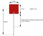
Le corps de résistance carré percé est étudié dans la section de mesure de la soufflerie HM 170.
