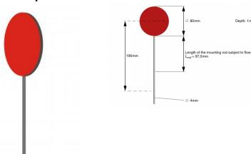
Le corps de résistance disque circulaire est étudié dans la section de mesure de la soufflerie HM 170.
