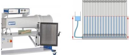
Le manomètre HM 170.50 sert à indiquer simultanément jusqu'à 16 pressions différentielles mesurées en millimètres de colonne d'eau.
