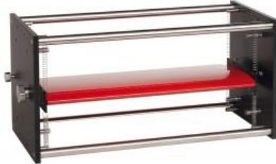
Le modèle à aile est suspendu de façon flexible dans un châssis externe à l'aide de huit ressorts. L'aile peut ainsi effectuer des vibrations torsionnelles et transversales. Le châssis est simplement fixé avec des vis dans la section de mesure de la soufflerie. Les butoirs situés sur le châssis évitent de trop grandes déviations de l'aile pendant l'exécution de l'essai.
