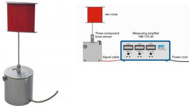
Un corps de portance ou de résistance est utilisé dans le capteur de force HM 170 qui émet la force de traînée et de portance comme valeur mesurée lors de l'écoulement le long du corps.
