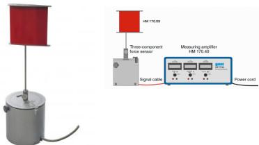
Un corps de portance ou de résistance est utilisé dans le capteur de force HM 170 qui émet la force de traînée et de portance comme valeur mesurée lors de l'écoulement le long du corps.
