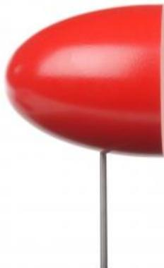
Le corps de résistance paraboloïde est étudié dans la section de mesure de la soufflerie HM 170.
